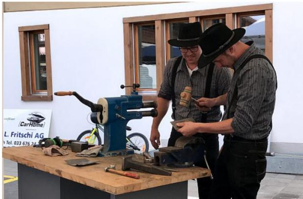
Yves Fuhrer (l.) und Patrick Balmer bearbeiten ein Stück Blech, aus dem ein Kotflügel für einen Oldtimer wird. Foto: Herbert Kobi
